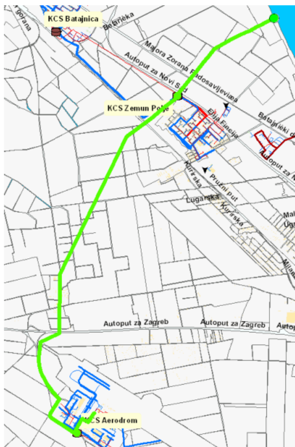
слика 5. Ситуација колектора и потисних водова на правцу КЦС „Аеродром“ – КЦС „Земун поље 2“ – излив у реку Дунав
