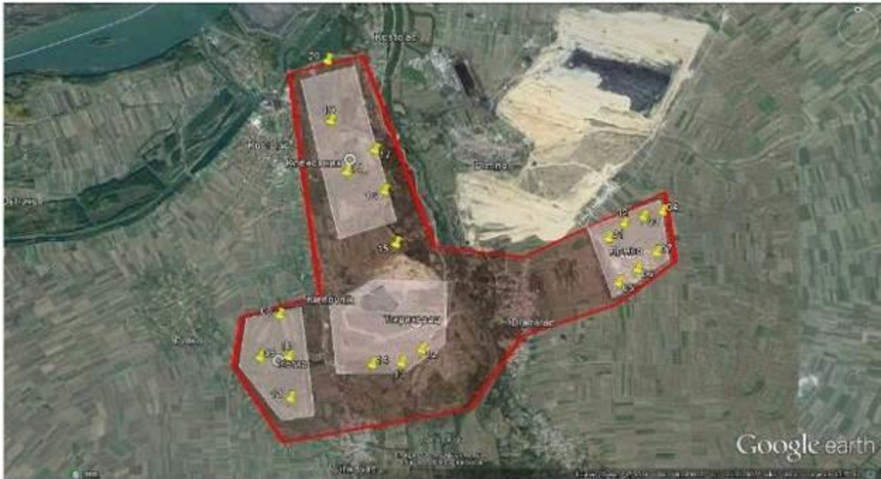
Слика 2.17. Инцијална варијанта позиција ветротурбина ветроелектране Костолац према Генералном пројекту. Извор: ЈП ЕПС (Генерални пројекат).
