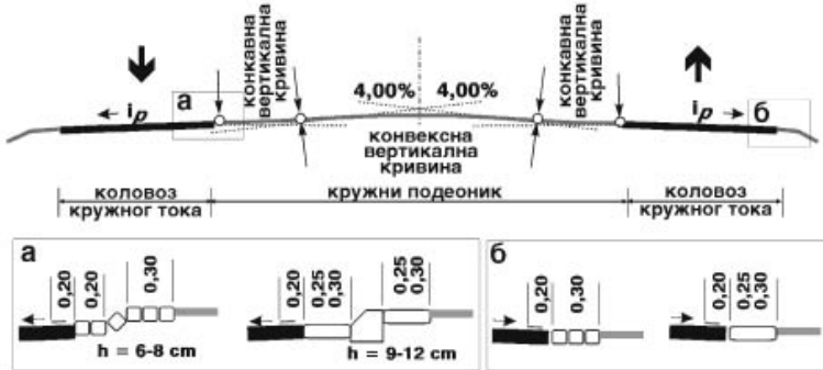
Слика 4-21: Обликовање ивица кружног коловоза .
