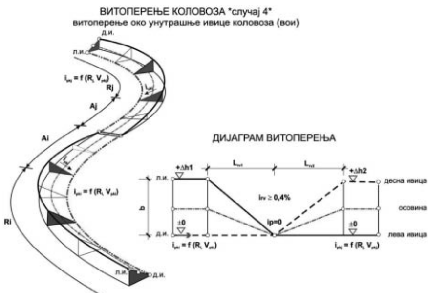
Слика 8-06: Континуална промена попречног профила - витоперење око ивице коловоза.
