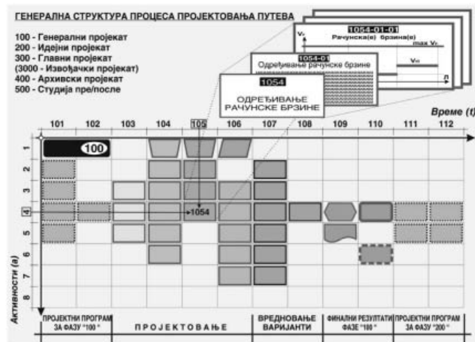
Слика 2-09: Генерални приказ структуре процеса пројектовања путева.
