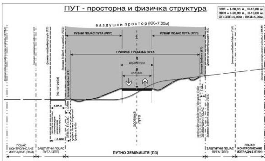
Слика 5-01: Основни елементи просторне и физичке структуре двотрачног пута.
