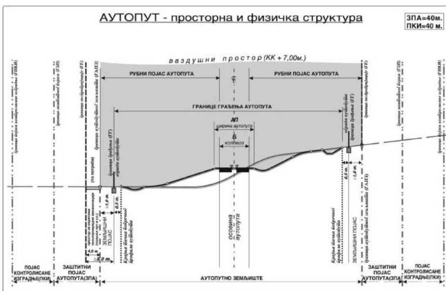
Слика 5-02: Основни елементи просторне и физичке структуре аутопута.
