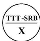
Слика 2. Жиг за прво оверавање тахографа, где „ттт” представља ознаку типа тахографа а „x” представља бројчану ознаку радионице
