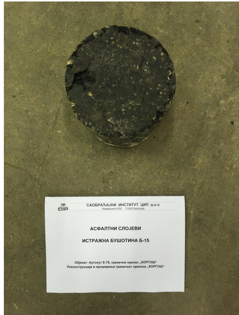
Слика П16.14 Горња површина узорка асфалтних слојева из бушотине Б – 15, km 0+120.48
