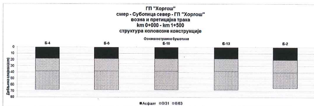
Слика 17 – структура коловозне конструкције возна и претицајна трака, смер Суботица север – ГП „Хоргош“
