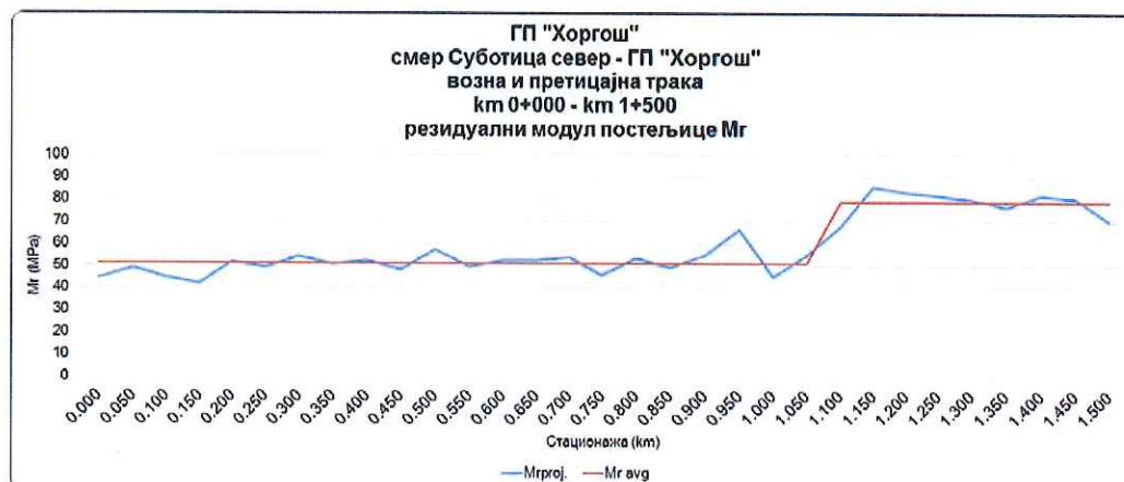
Слика 25 – резидуални модул постелџице возна и претицајна трака – смер Суботица север – ГП „Хоргош“
