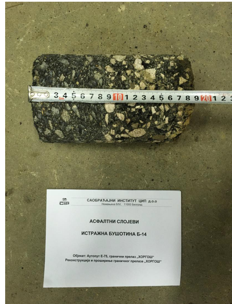
Слика П16.12 Узорак асфалтних слојева из бушотине Б – 14, km 0+073.52
