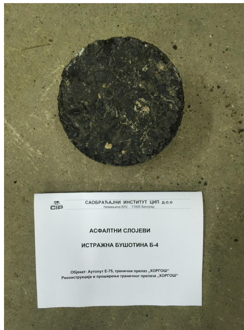
Слика П16.4 Горња површина узорка асфалтних слојева из бушотине Б – 4, km 0+970.27
