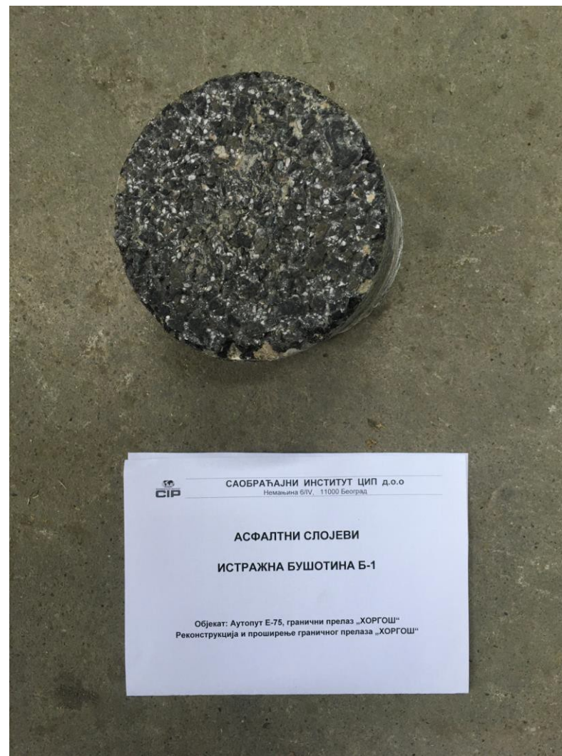
Слика П16.2 Горња површина узорка асфалтних слојева из бушотине Б – 1, km 1+258,38
