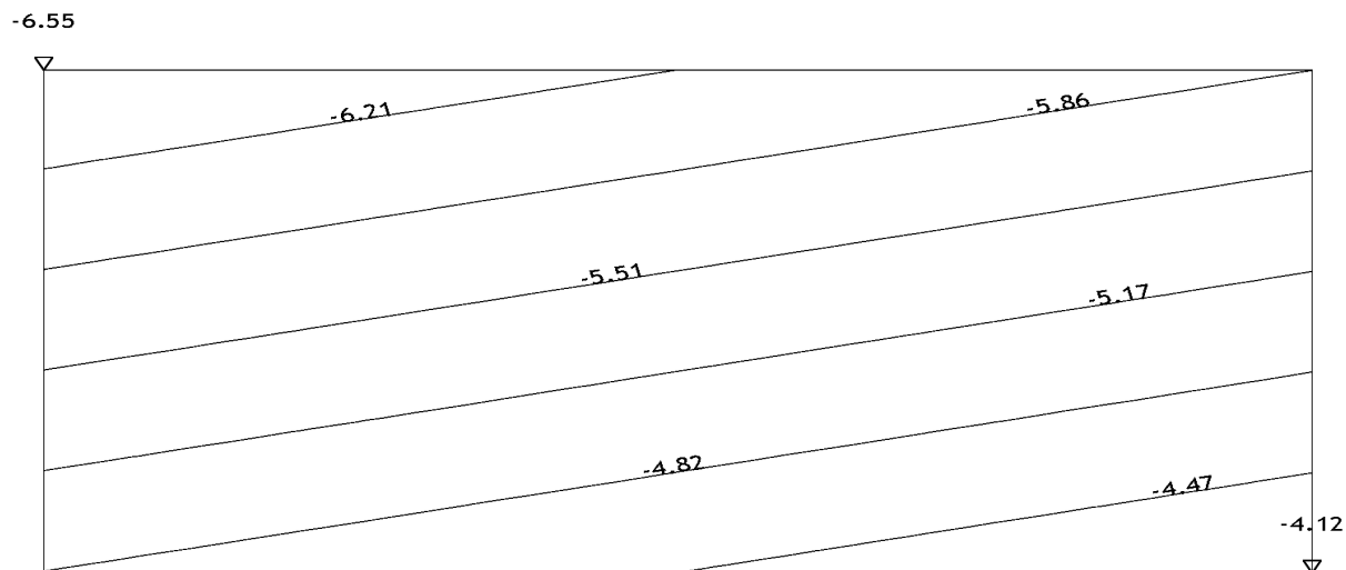
Nivo: Temeljna ploca [0.00 m] Uticaji u pov. osloncu: max \sigma_{tla} = 95.15 / min \sigma_{tla} = 59.83 \text{ kN/m}^2 Opt. 11: I+II+III
